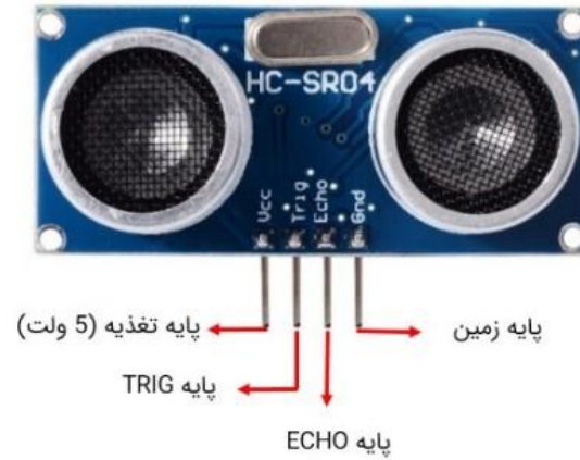
شکل ۶-۵: پایه های سنسور التراسونیک
