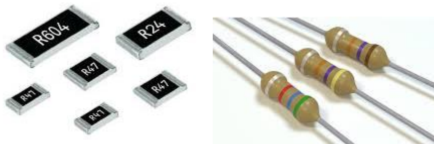
شکل (۳): تصویر مقاومت، (الف) DIP، (ب) SMD
