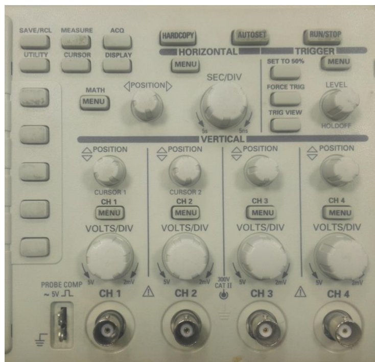
شکل (۷-۱) کار انواع دکمه های مربوط به اسیلوسکوپ
