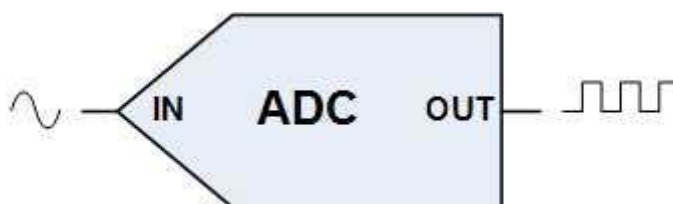
شکل ۱-۲۵: نماد قراردادی یک مبدل آنالوگ به دیجیتال
