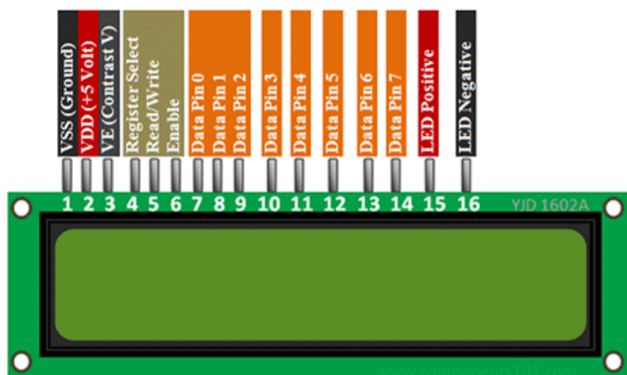
شکل ۲-۳ تصویر LCD کاراکتری ۱۶*۲
